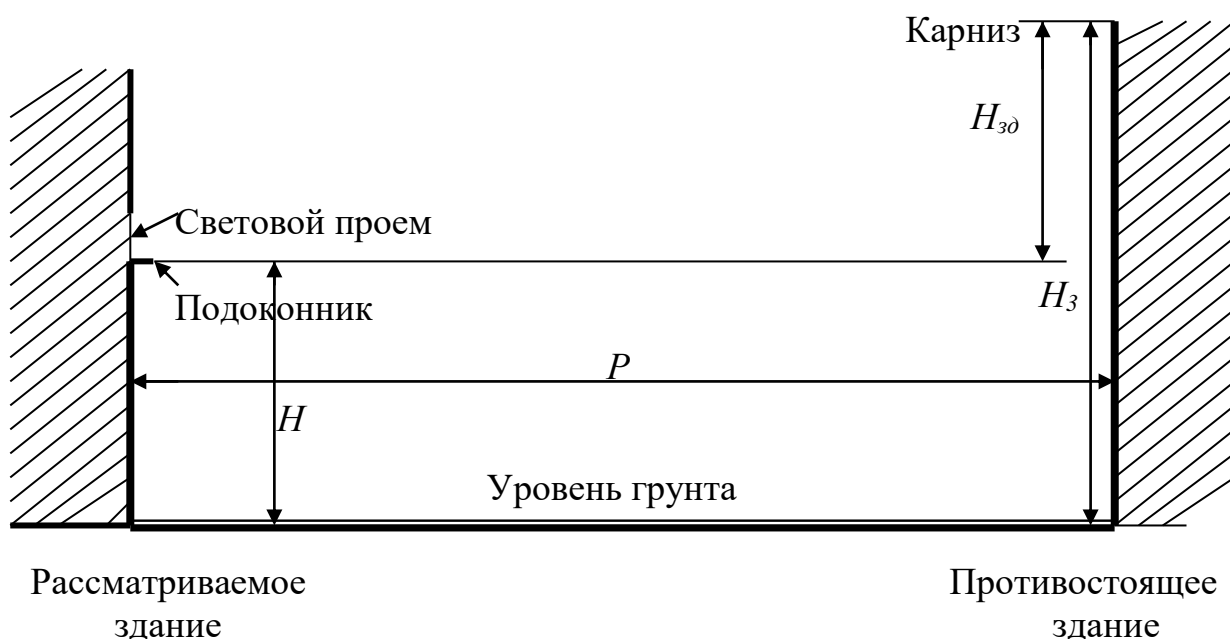
Рисунок 2.2 – Вертикальный разрез рассматриваемого и противостоящего здания
