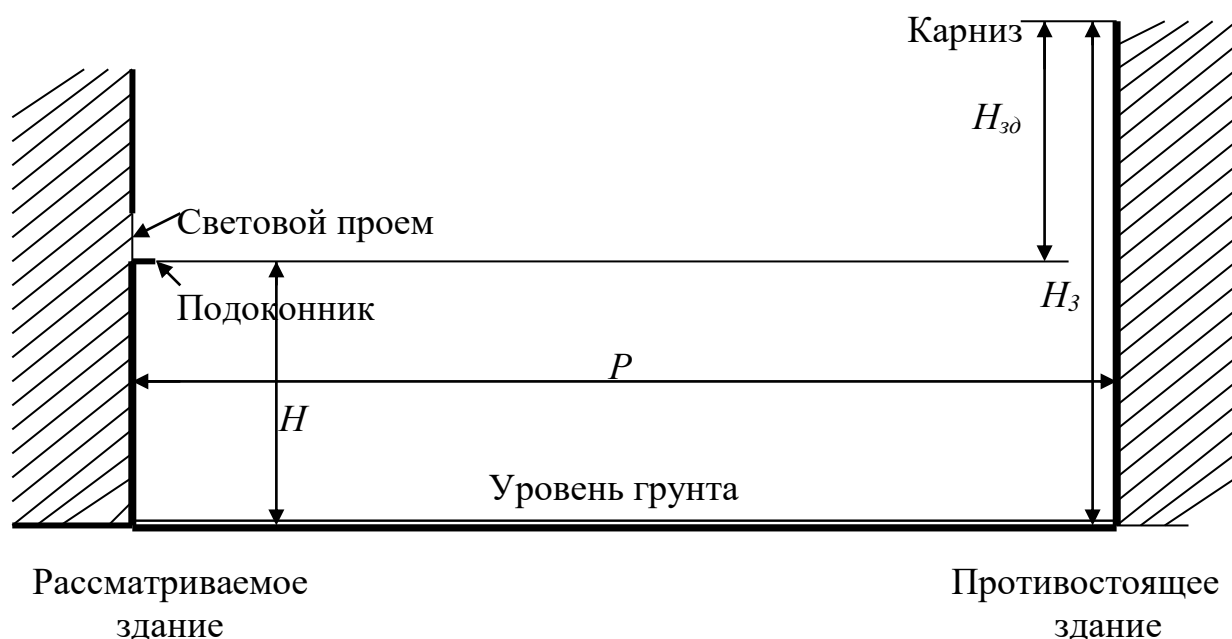
Рисунок 2.2 – Вертикальный разрез рассматриваемого и противостоящего здания
