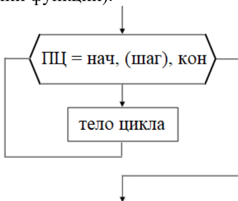
Рисунок 22 –Блок-схема алгоритмической структуры цикл с параметром
