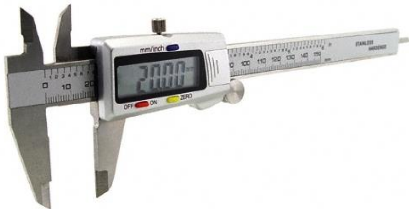
Рис. 5 Штангенциркуль с цифровой индикацией
