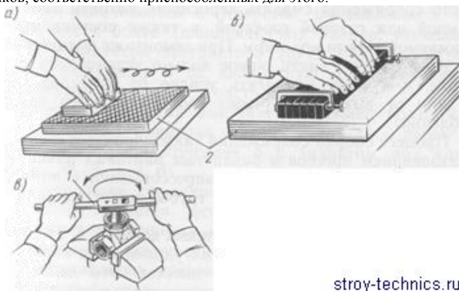
Рис. 2. Приемы притирки деталей:
