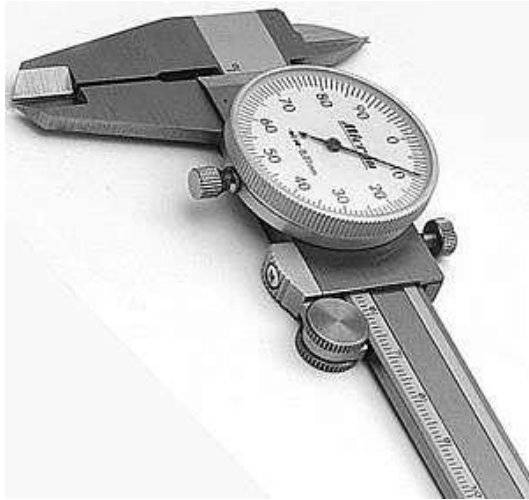
Рис.4 Штангенциркуль со стрелкой на круговой шкале
