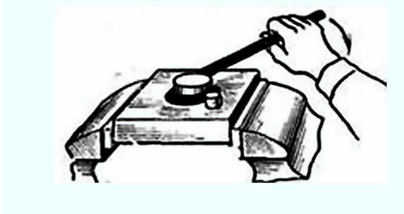
Рисунок 2. Приспособление для гибки кольца
