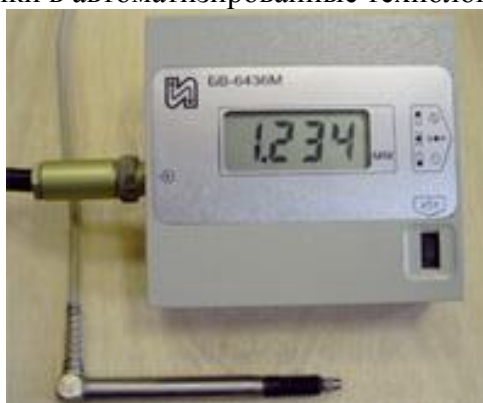
Рис. 1. Система измерительная портативная с индуктивным преобразователем мод. БВ-6436М.
