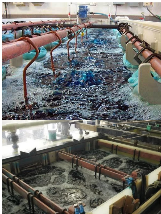
Рисунок 1 – Ванны для электроосаждения защитного покрытия на детали
