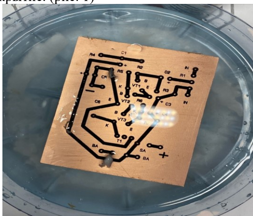
Рисунок 1 – Отпечатывание тонера на медной поверхности стеклотекстолита
