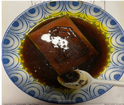
Рисунок 2 – Травление заготовки в хлорном железе
