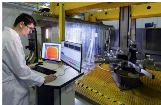
Рисунок 2 – Система ультразвукового контроля деталей авиационных двигателей на рыбинском предприятии ОДК-Сатурн
