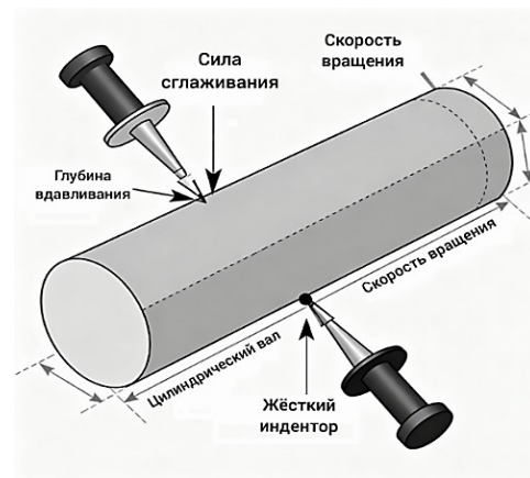
Рисунок 1 – Схема процесса выглаживания цилиндрической оси
