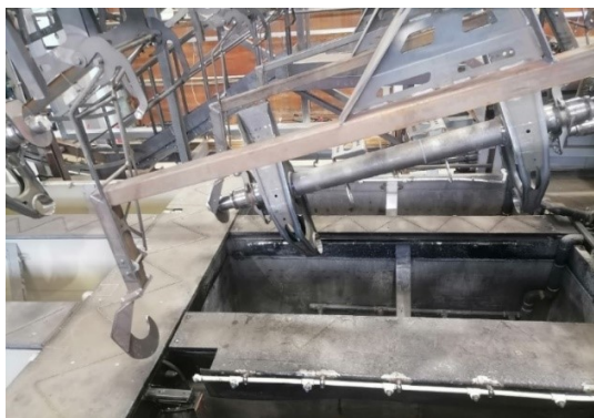
Рисунок 2 – Ванны для покрытия осей грузовых автомобилей защитным слоем
