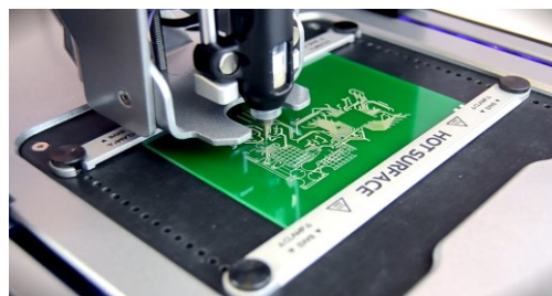
Рисунок 7 – Нанесение токопроводящего слоя на текстолит
