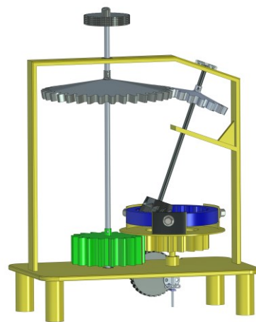
Рисунок 2 – Демонстрационный стенд скайвинг-станочного зацепления
