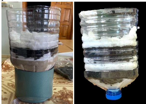
а – с песком и активированным углем; б – с активированным углем и марлей Рисунок 1 – Конструкции фильтров для проведения испытаний
