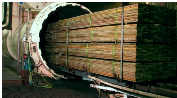
Рисунок 1 – Технология автоклавной пропитки под давлением
