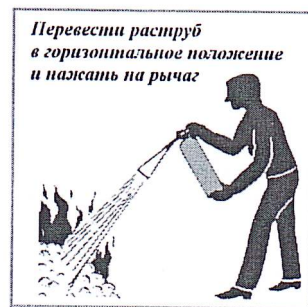
Рис. 8. Приведение в действие ручного углекислотного огнетушителя (плакат)
