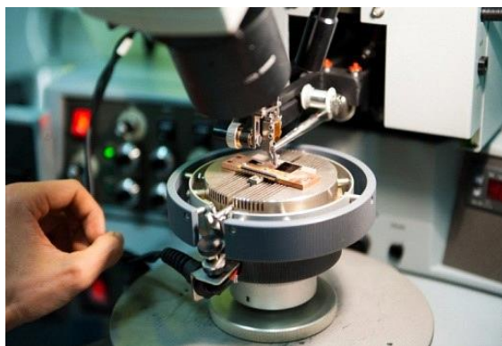
Рисунок 1 – Сенсор, обнаруживающий дефекты в кубитных микросхемах
