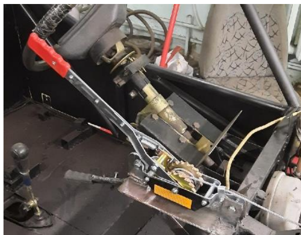
Рисунок 3 - Механизм подъема и фиксации отвала
