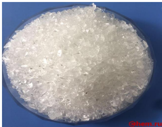
Рисунок 2 – Фторид кальция, полученный из нефтяных отходов
