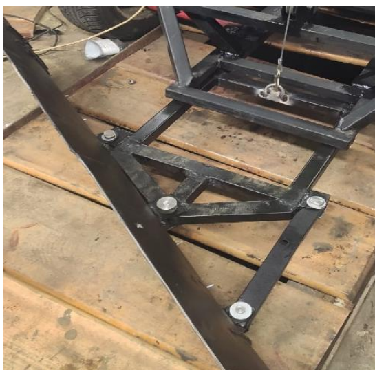
Рисунок 2 - Механизм поворота и фиксации в трёх положениях
