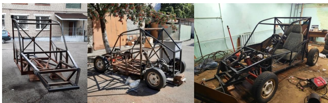
Рисунок 2 – Этапы изготовления багги
