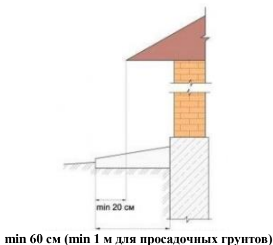
Рисунок 4 – Рекомендуемые размеры отступов для отмосток
