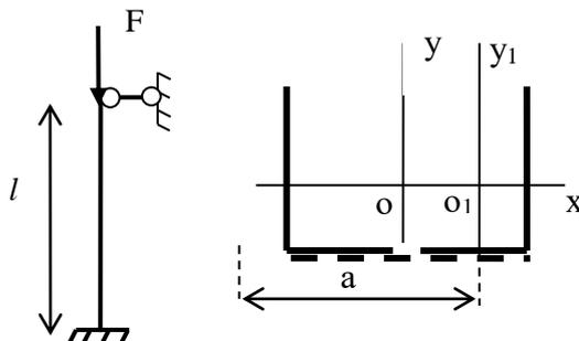
**Задача 3.** Для сжатой стойки с заданной схемой закрепления и поперечного сечения подобрать стандартные профили, определить расстояние между элементами сечения, обеспечивающее равную устойчивость стойки относительно осей  $ox, oy$ .
