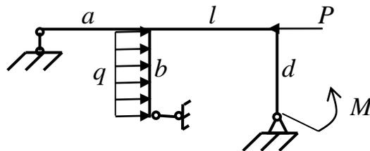
**Задача 2.** В пространственной раме из стали  $[\sigma] = 160$  мПа стержень у заделки – прямоугольного сечения с размерами  $h$  и  $b$ , остальные – круглого сечения диаметром  $d$ .
