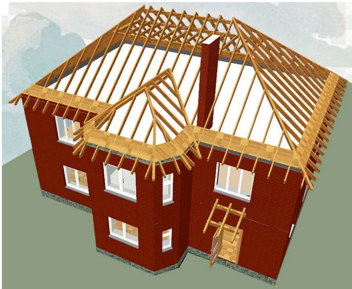
Рисунок 24 – Стропильная система двускатной вальмовой крыши с эркером
