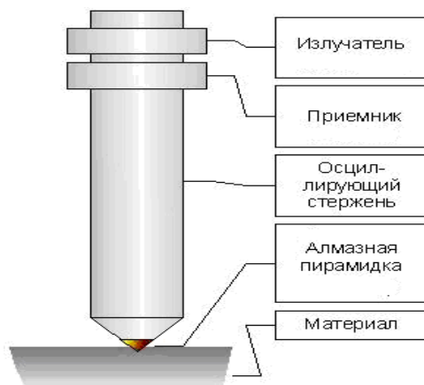
Рисунок 4 – Схема устройства и действия зонда UCI
