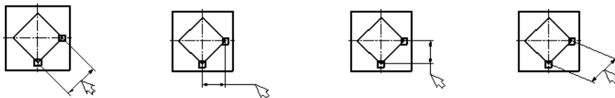
Рисунок 19 – Способы простановки размеров между узлами
