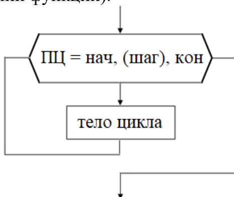
Рисунок 22 –Блок-схема алгоритмической структуры цикла с параметром
