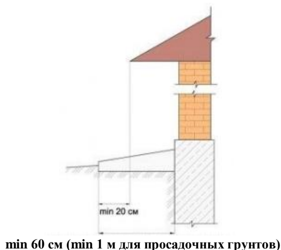
Рисунок 4 – Рекомендуемые размеры отступов для отмосток
