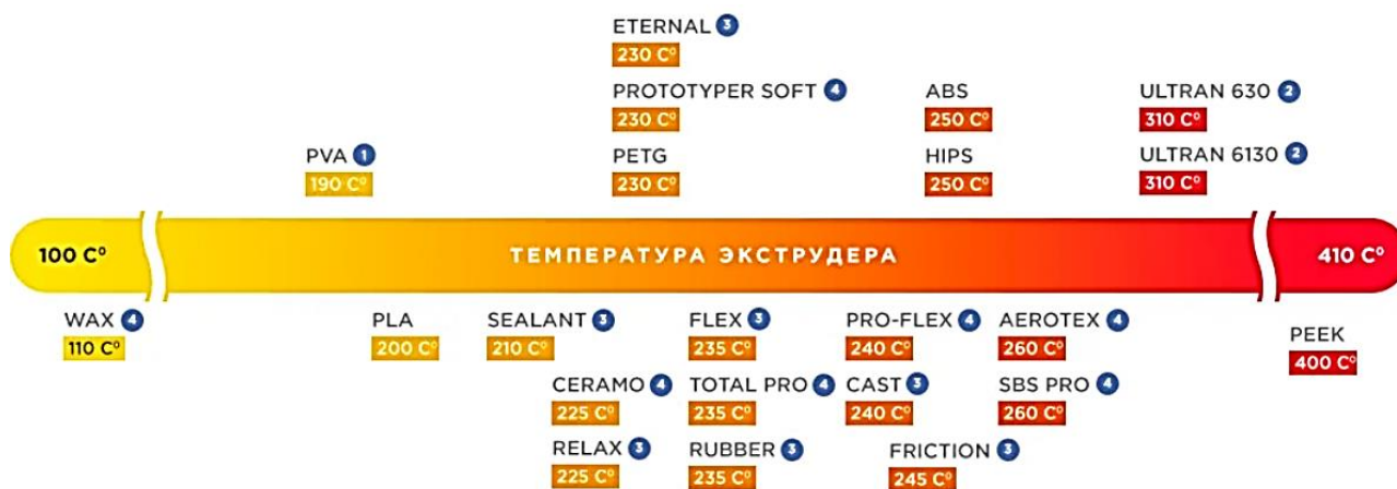
Рисунок 1.3 – Филаменты для FFF печати и характерные температуры экструзии
