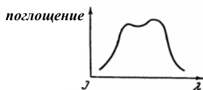
Рисунок 1 – Пример зависимости поглощения светофильтра от длины волны
