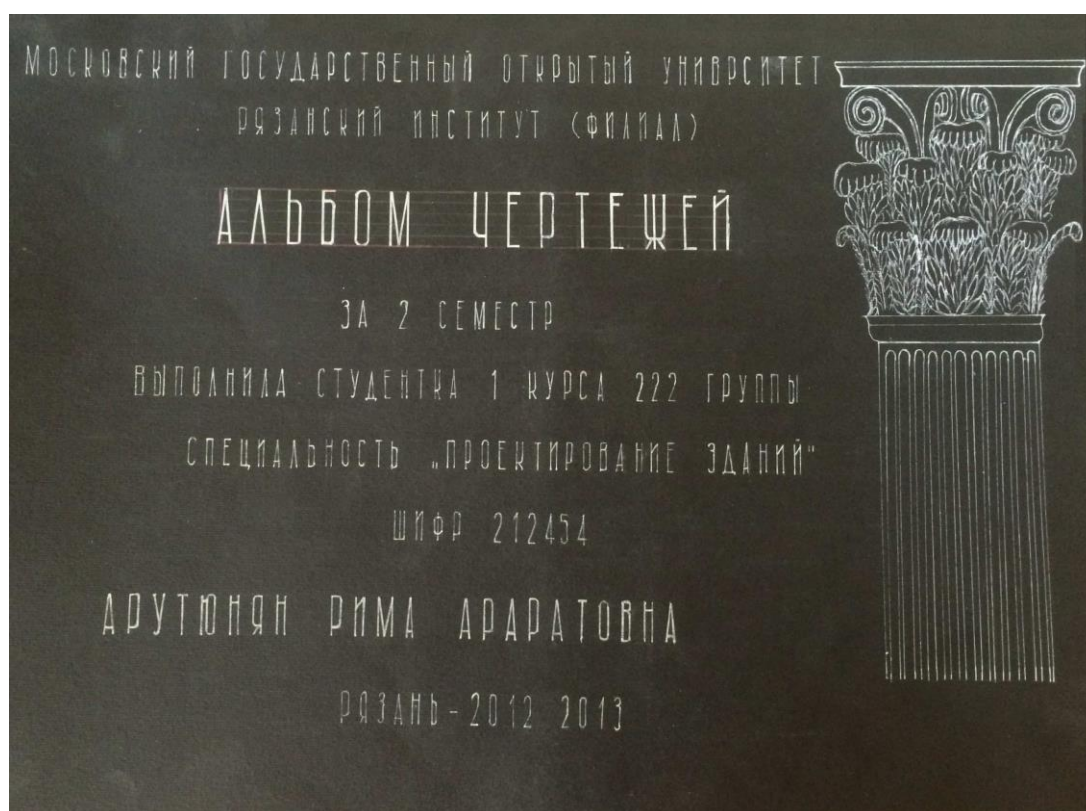
Рисунок 5.4- Пример оформления титульного листа альбома чертежей архитектурным узким шрифтом
