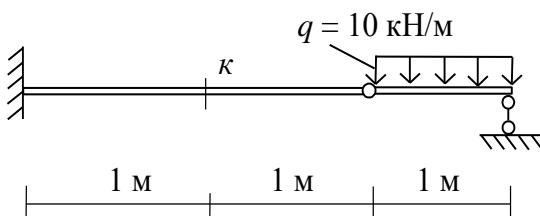
Определить значение изгибающего момента в сечении «*k*» используя аппарат линий влияния
