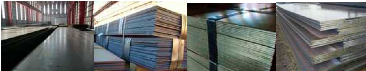
Рисунок 1.4 – Складирование листового материала на металлургических заводах
