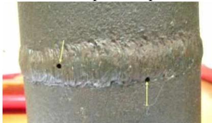
11. Как называется углубление, образующееся в конце валика вследствие давления дуги и объемной усадки металла шва?
