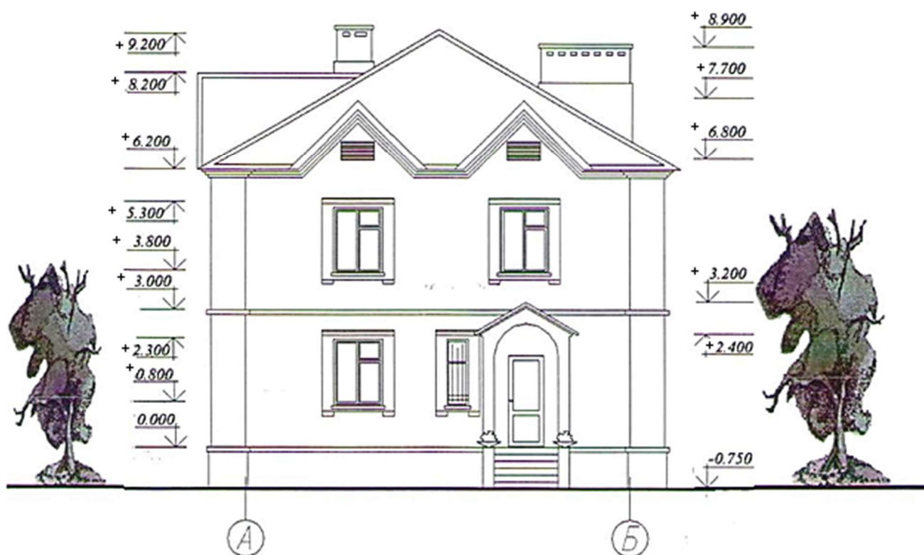
Рисунок 37 – Фасады здания в осях 1-3 и А-Б
