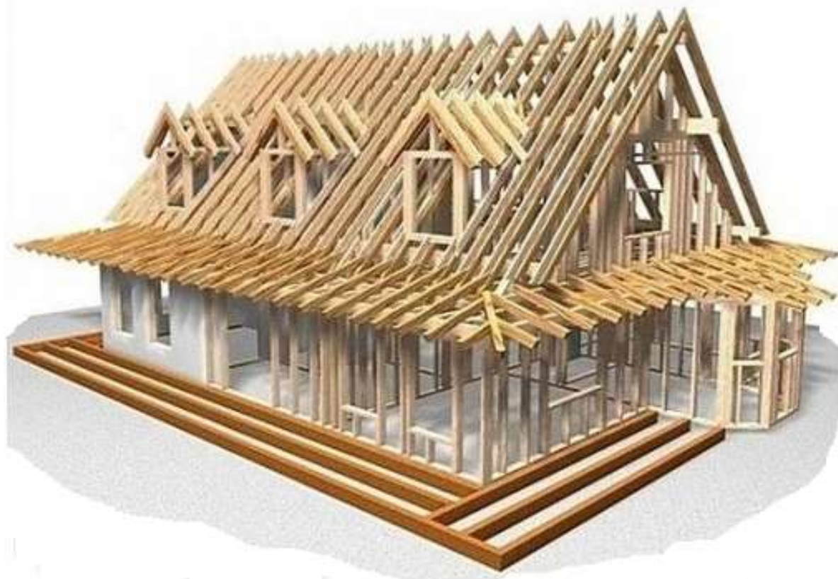
Рисунок 22 – Наглядное изображение стропильной системы мансардной крыши
