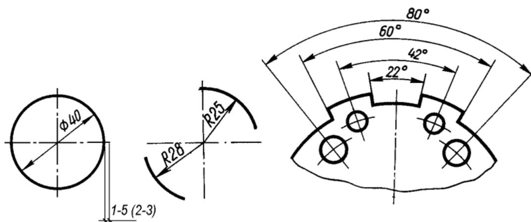
Рисунок 1.1 – Случаи применения стрелок на размерных линиях
