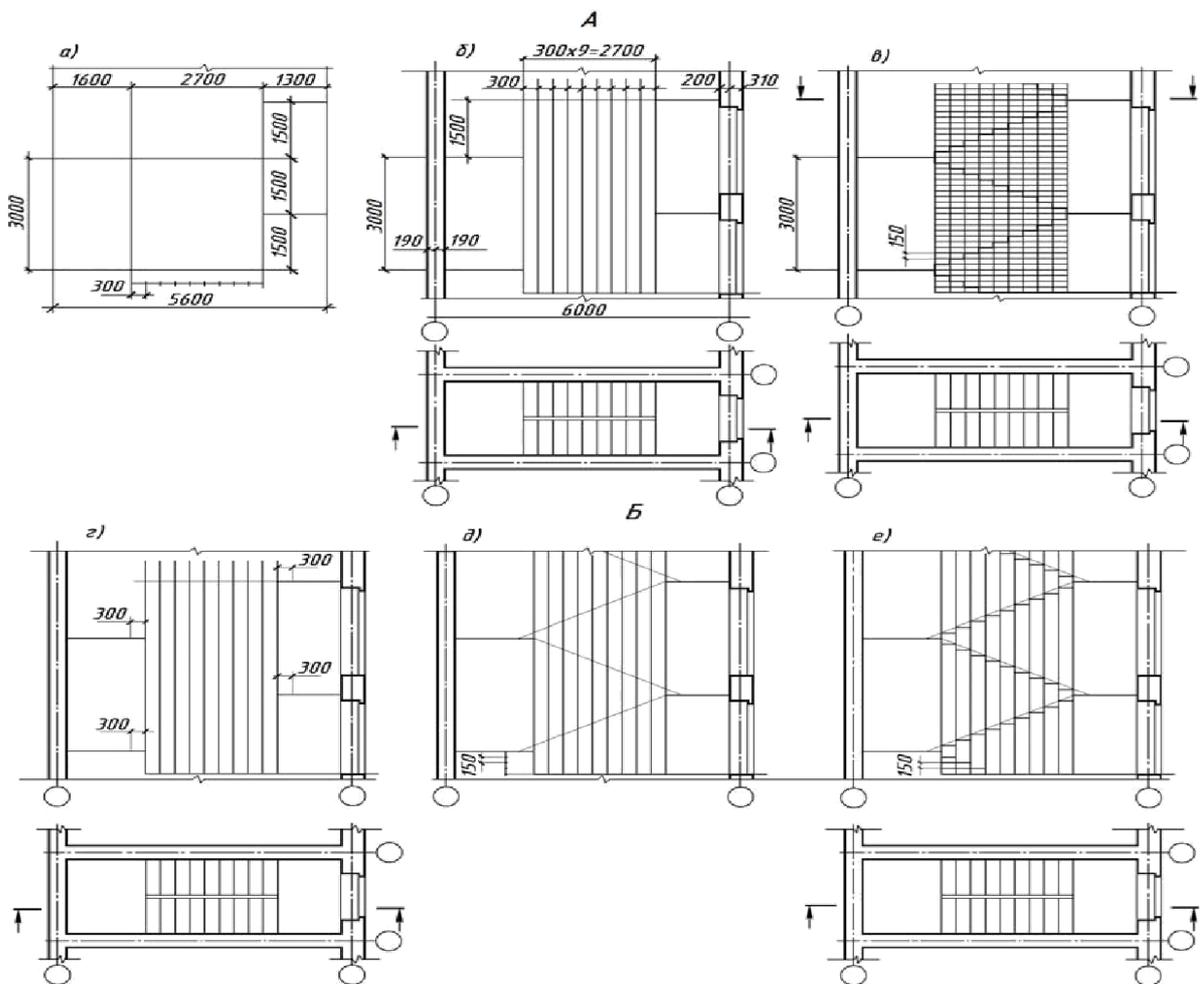
Рисунок 4.5 – Графическая разбивка лестничной клетки
