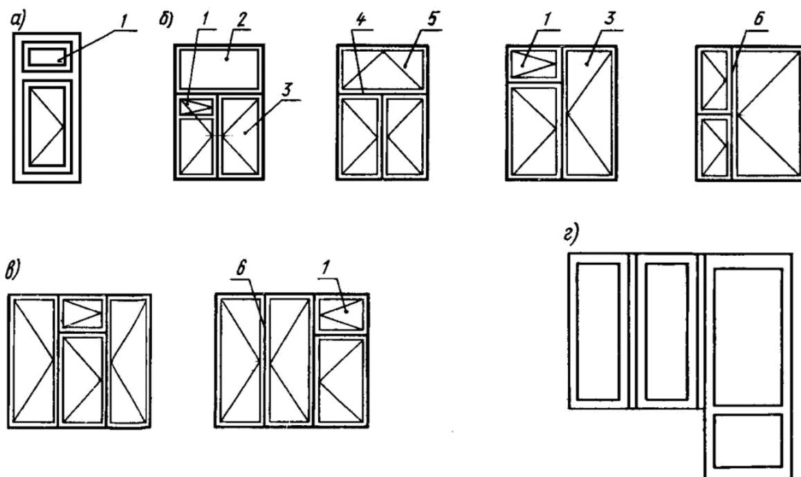
а – одностворчатое; б – двухстворчатое; в – трёхстворчатое; г – с балконной дверью
