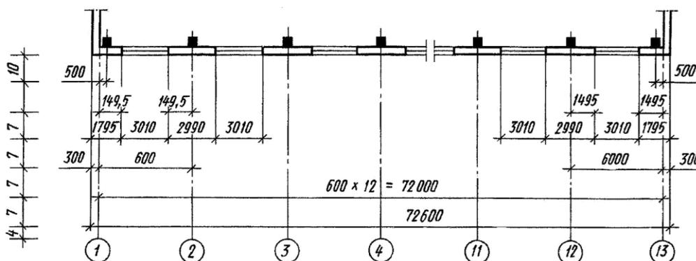
Рисунок 1.3 – Простановка размеров на планах зданий
