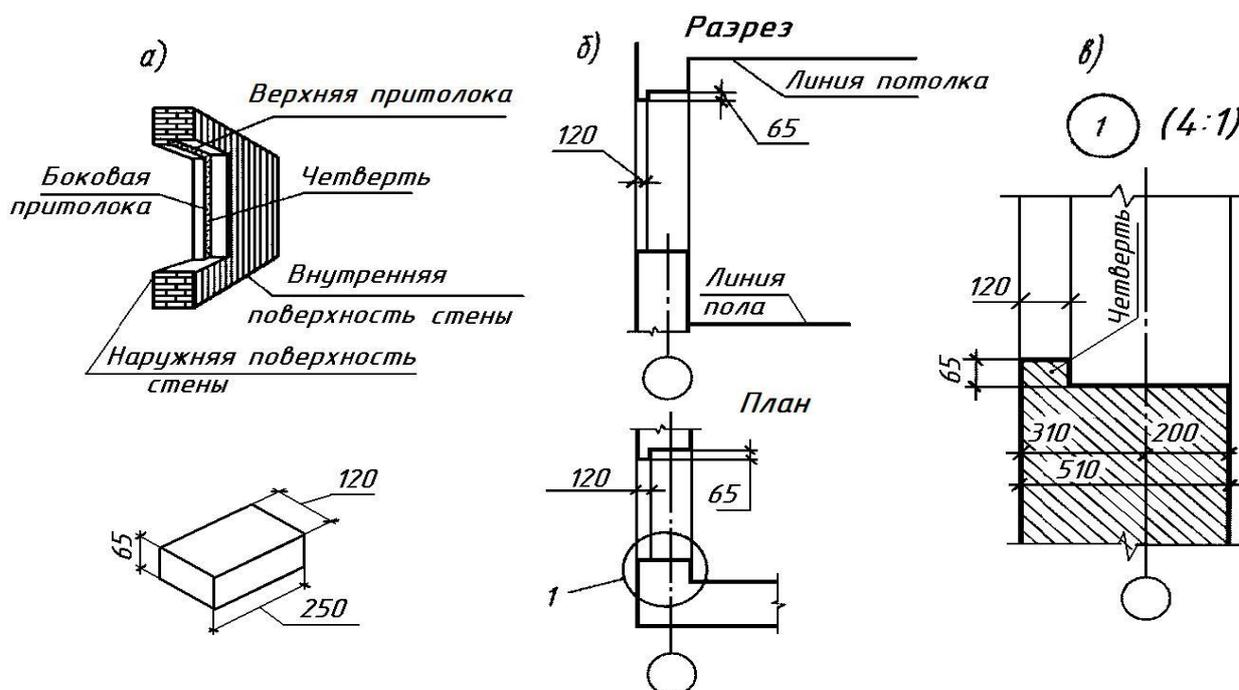
Рисунок 4.8 – «Четверть» и её изображение на чертеже
