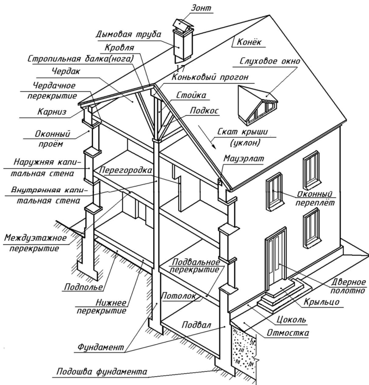
Рисунок 2.3 – Здание со стропильной крышей
