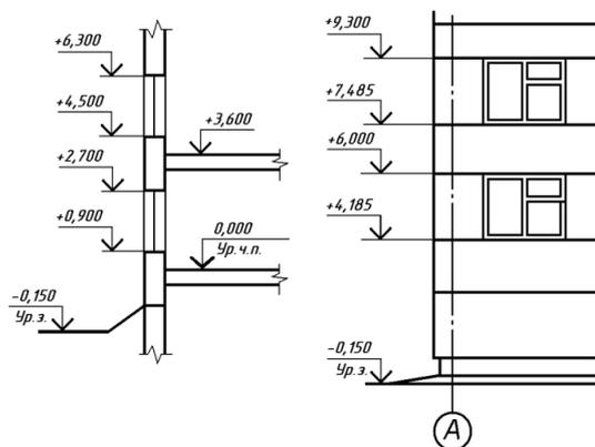
Рисунок 1.5 – Простановка отметок на разрезах и фасадах
