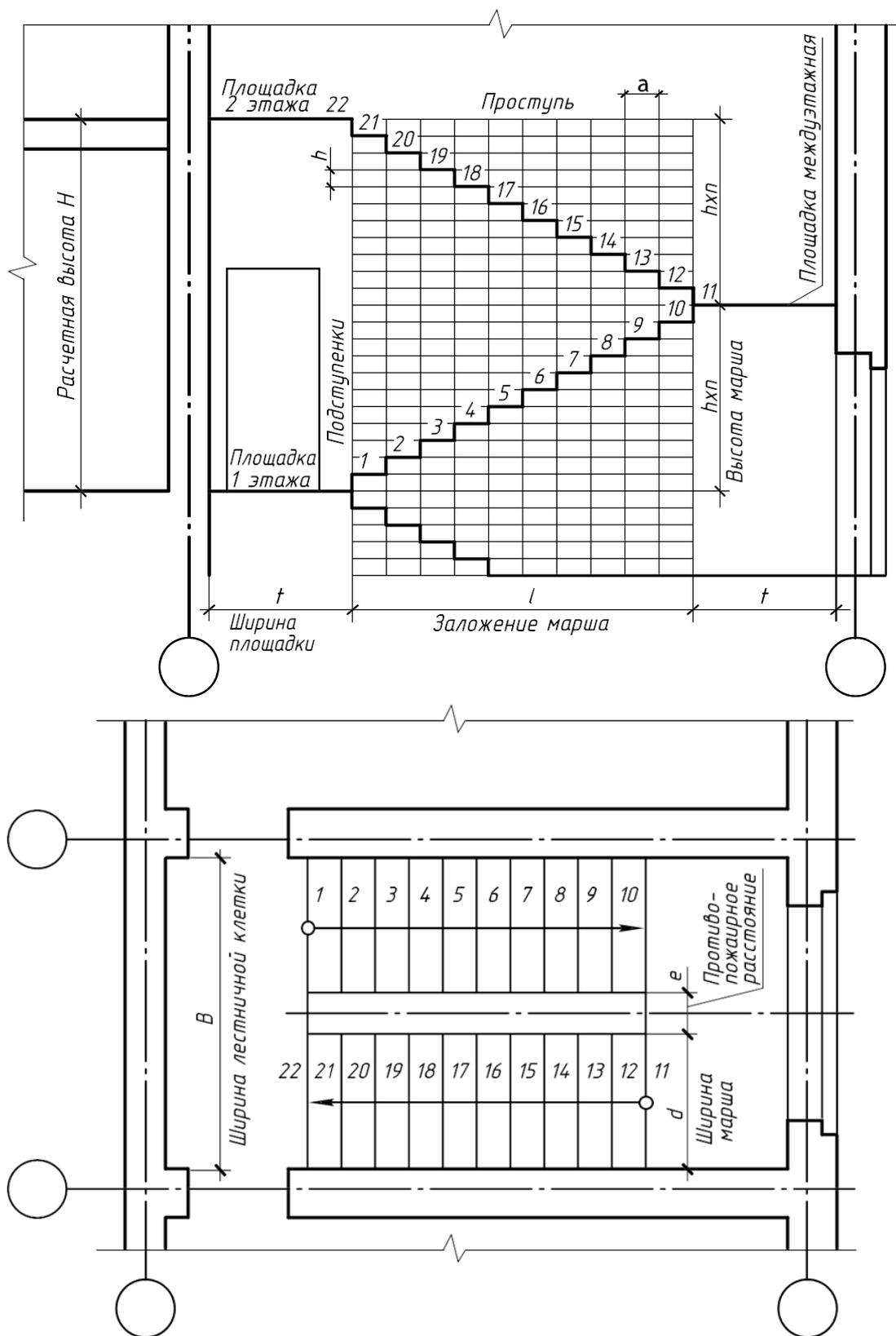
Рисунок 4.7 – Графическая разбивка лестницы
