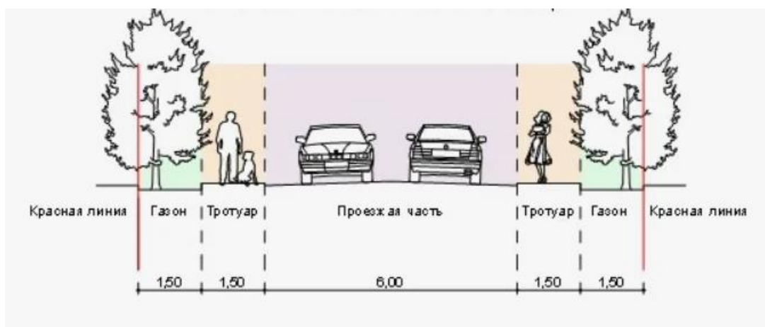
Рисунок В.7 – Образец выполнения построения поперечного профиля улицы (общий случай).
