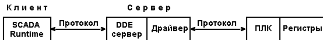
Рис. 2.4. Обмен информацией с помощью DDE-протокола.
