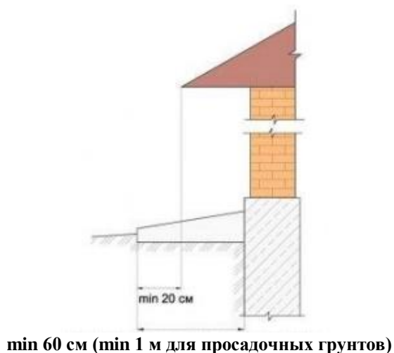
Рисунок 4 – Рекомендуемые размеры отступов для отмосток
