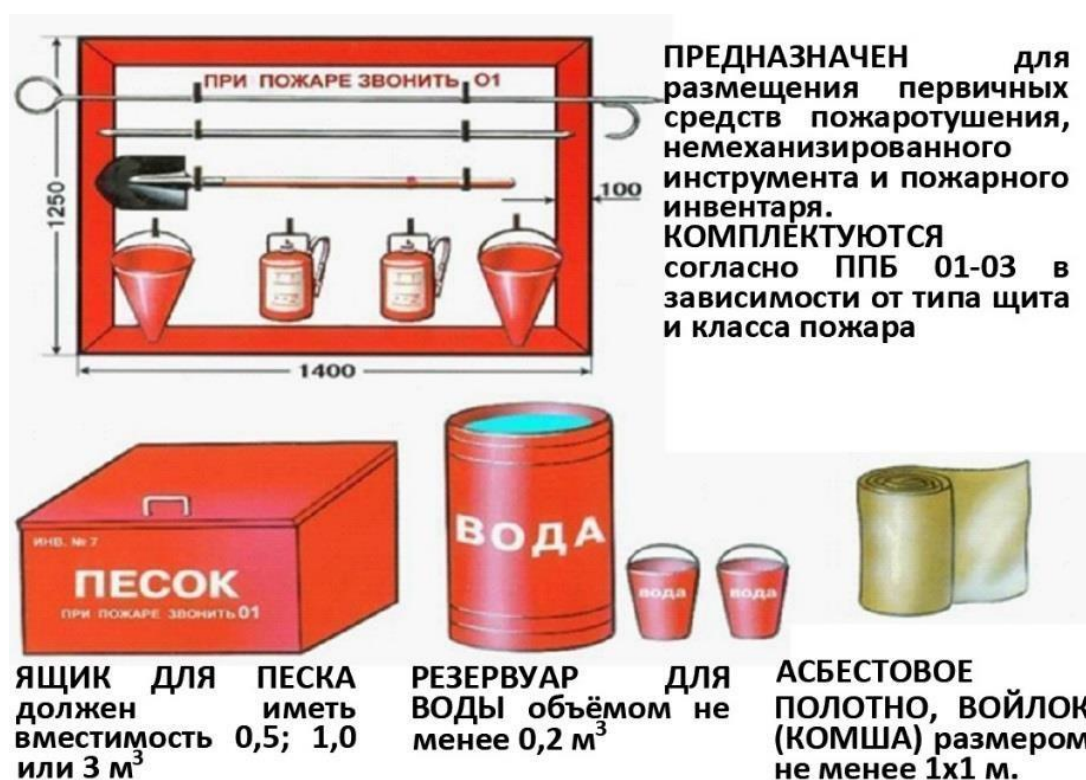
Рисунок 5.5 – Первичные средства пожаротушения строительной площадки
