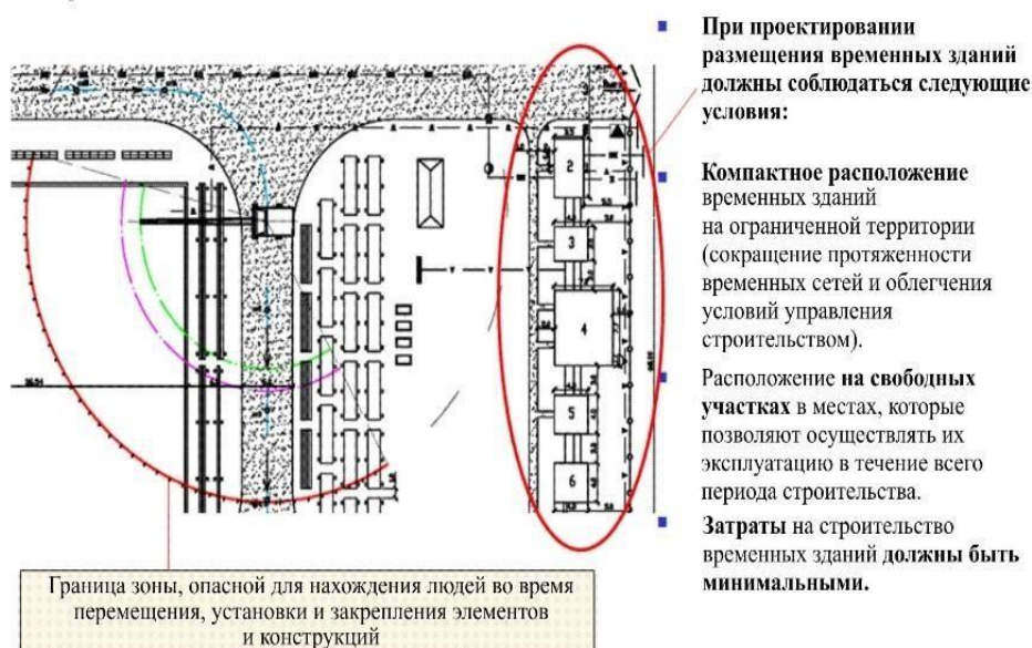
Рисунок 5.4 – Правила размещения временных зданий на строительной площадке
