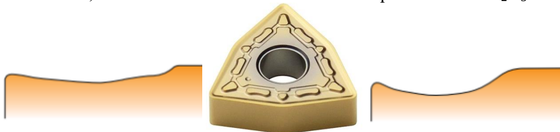
Рисунок 6.3 – Пластина WNMG 080408 (в центре) и формы ее стружколома для черновой (слева) и чистовой обработки (справа)
