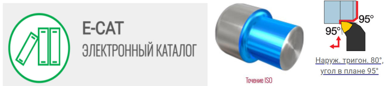
Рисунок 6.4 – Вход в интерактивный каталог, выбор вида обработки, типа и расположения пластины в державке
