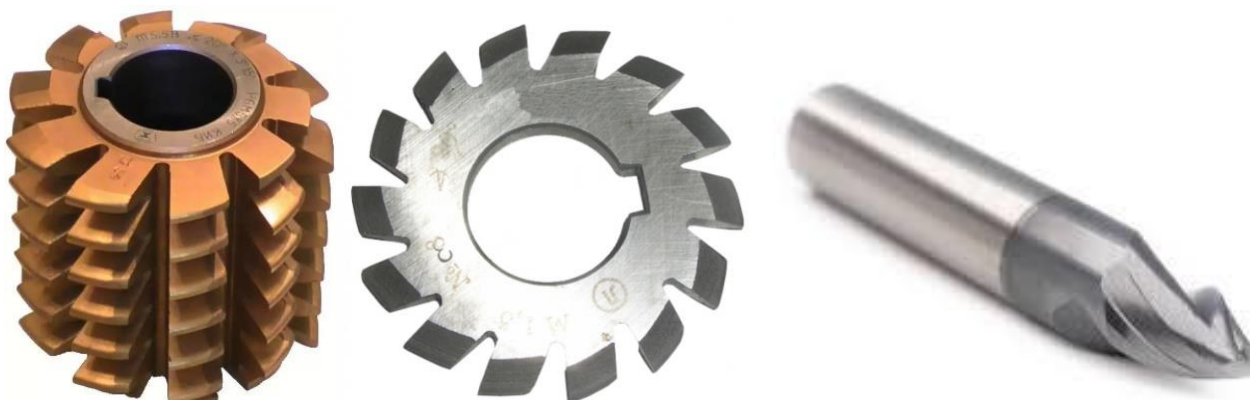
Рисунок 3.13 – Фрезы для зубообработки: червячная (слева), дисковая модульная (в центре) и пальцевая модульная (справа)
