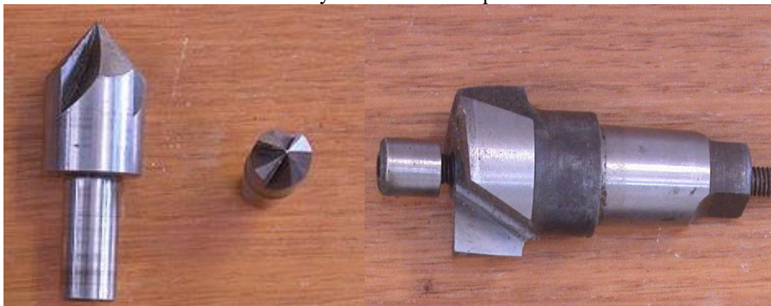
Рисунок 3.20 – Зенковка (слева) и цековка (справа)
