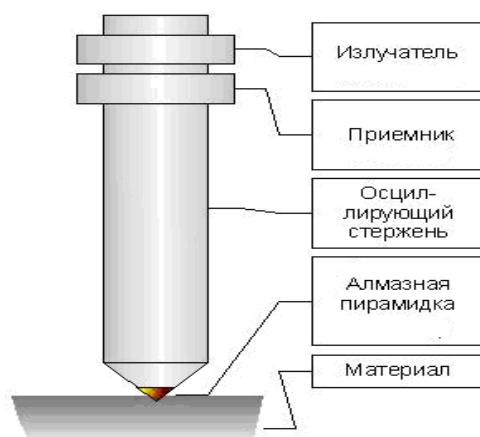
Рисунок 4 – Схема устройства и действия зонда UCI
