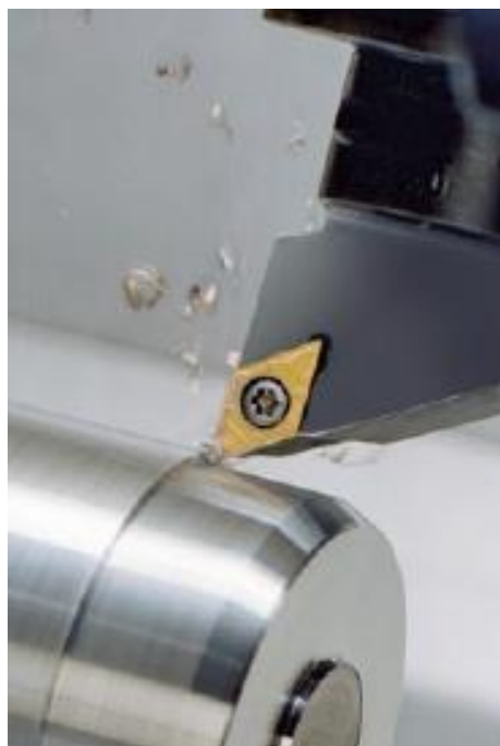
Рисунок 1.5 – Закрепление пластины винтом
