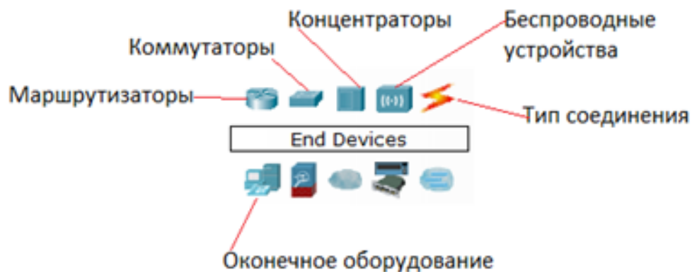
Рисунок 2 – Панель оборудования Packet Tracer (Основные типы оборудования)
