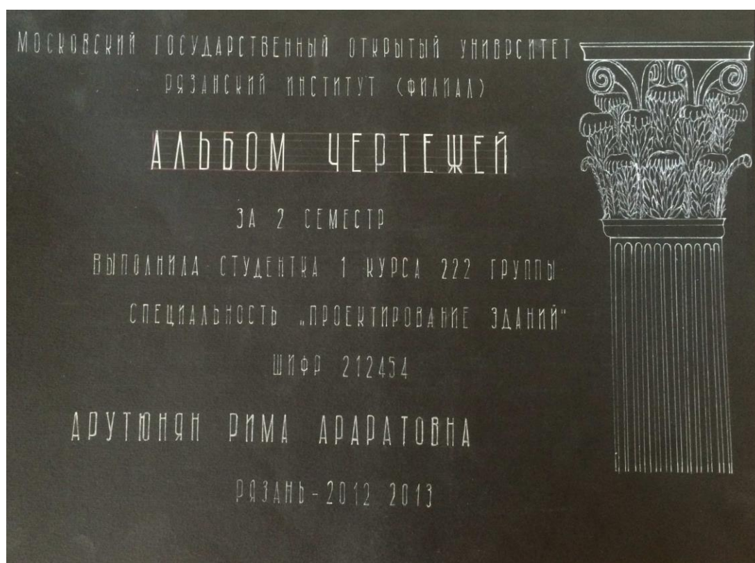
Рисунок 5.3- Пример оформления титульного листа альбома чертежей архитектурным узким шрифтом
