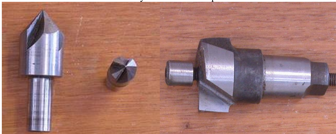
Рисунок 3.20 – Зенковка (слева) и цековка (справа)
