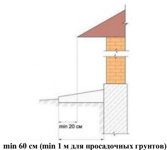
Рисунок 4 – Рекомендуемые размеры отступов для отмосток
