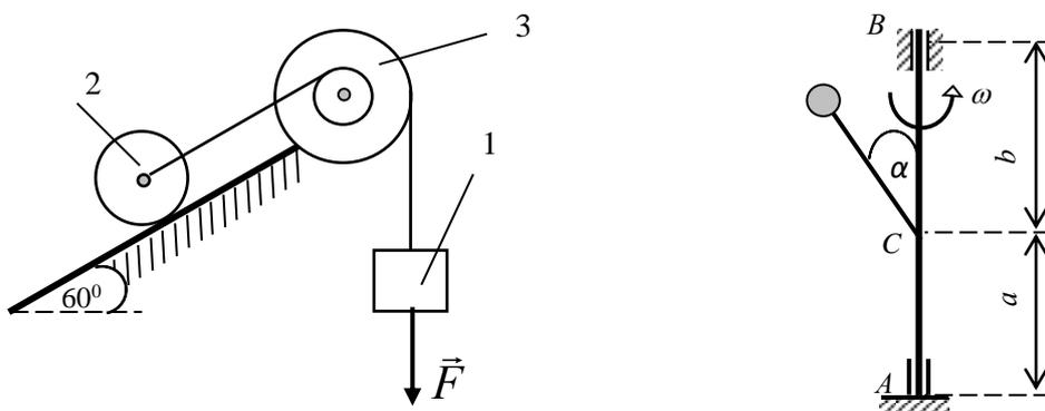
**Задача 3.3.** Вертикальный вал  $AB$ , вращающийся с постоянной угловой скоростью  $\omega$  закреплен подпятником в точке  $A$  и цилиндрическим подшипником в точке  $B$ . К валу жестко прикреплен невесомый стержень длиной  $l$  с точечной массой  $m$  на конце. Пренебрегая весом вала, определить реакции подпятника  $A$  и подшипника  $B$ .
