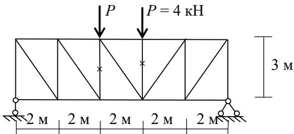
Определить усилия в отмеченных стержнях
