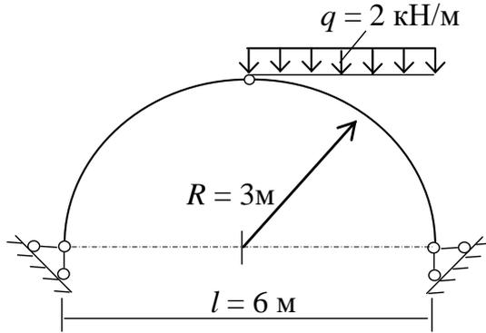
Определить опорные реакции в трехшарнирной арке
