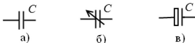
а) нерегулируемый; б) регулируемый; в) электролитический
