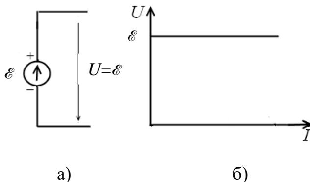
а) обозначение идеального источника напряжения в схеме;
