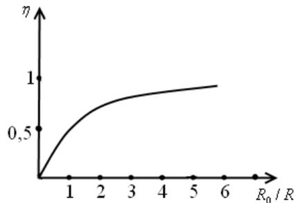
Рисунок 13 – Зависимость  $\eta$  от отношения  $R_0/R$
