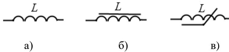
а) катушка индуктивности; б) катушка индуктивности с магнитопроводом; в) катушка индуктивности саморегулирующая
