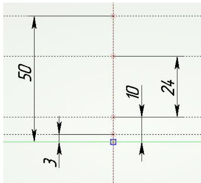
Рисунок 6 – Построение параллельных горизонтальных прямых и простановка контрольных размеров между ними
