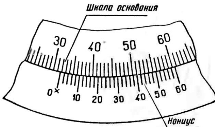
Рисунок 4 – Пример считывания результата измерения. Целое число градусов равно 31. Измеренное значение – 31^{\circ} 40'
