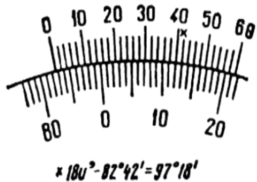
Рисунок 22 – Считывание показаний при измерении внутренних углов от 130° до 90°
